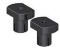
Le chiavette di locazione (due per set) sono usate per dare una locazione ai Qwik-Loks quando sono montati sulla tavola con scanalature a T. Esse utilizzano un meccanismo a sfera per il bloccaggio sulla base inferiore dei Qwik-Lok.
