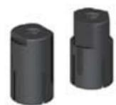
I set di spine tonde ed a diamante sono usate per locare il sistema Qwik-Lok (pagg.9-10) rapidamente e con accuratezza. Queste spine da Ø 12 mm utilizzano un meccanismo ad espansione con sfera incorporata per il bloccaggio quando sono montate direttamente sulla sovratavola. \*Il sistema 50 mm richiede un adattatore (# 081-0900).
